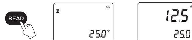
**Nota:** El indicador ATC parpadea y la compensación automática de temperatura se inhabilita si la temperatura sobrepasa el rango de 10-40°C .
