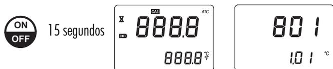
2. Mientras sigue manteniendo pulsada la tecla **ON/OFF**, pulse la tecla **ZERO**. La unidad de temperatura cambiará de °C a °F o viceversa.
