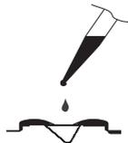
**Nota:** Si la temperatura de la muestra difiere significativamente de la temperatura del instrumento, espere aproximadamente 1 minuto a que alcance el equilibrio térmico.
